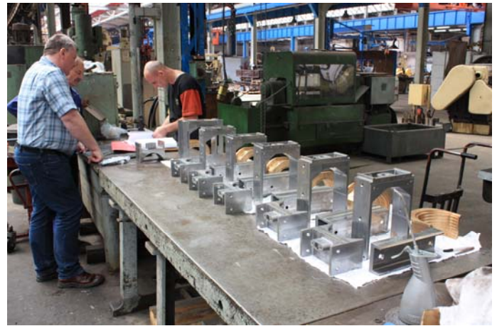
Die Achslager werden für das Einbringen des Weißmetallausguss vorbereitet und die Montage Teile zusammengestellt.
