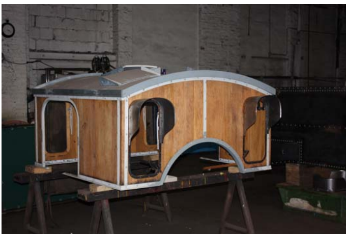
Am Oberteil des Führerhauses erfolgt die Vorbereitung des Anbaus der Fensterschuten.
