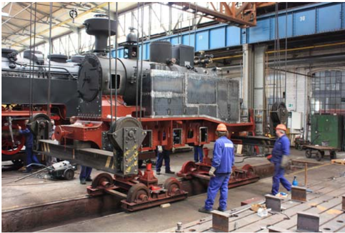
Damit in den nächsten Tagen der Einbau der Radsatzgruppe vorbereitet werden kann, wird der Rahmen auf zwei Hilfsgestelle umgesetzt.
