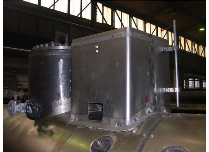
Anpassung des Sandkastens auf dem Kesselscheitel.
