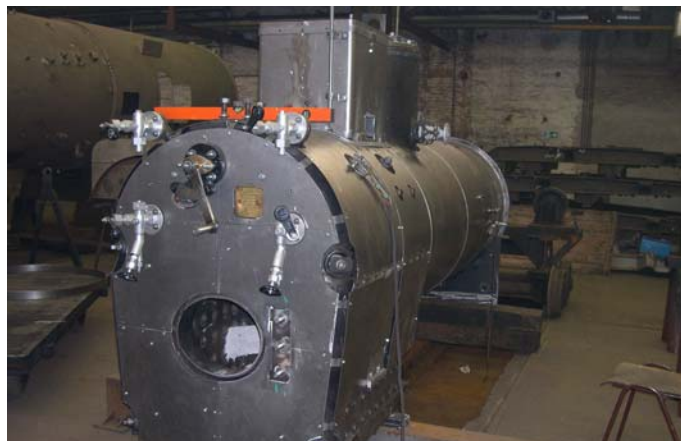
Die Verkleidungsbleche werden an den Kessel angepasst.
