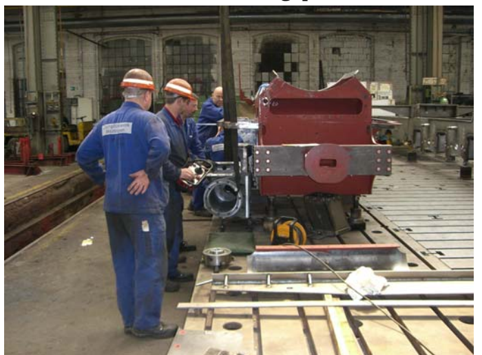
Mit dem Anbau der Zylinder an den Rahmen wurde begonnen.
