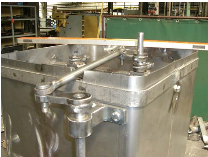
Die Betätigungsmechanik für den Sandkasten wird montiert.
