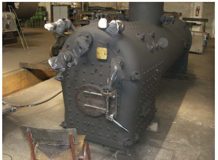
Der Kessel ist grundiert, die Feuertür wird an der Stehkesselrückwand angepasst.
