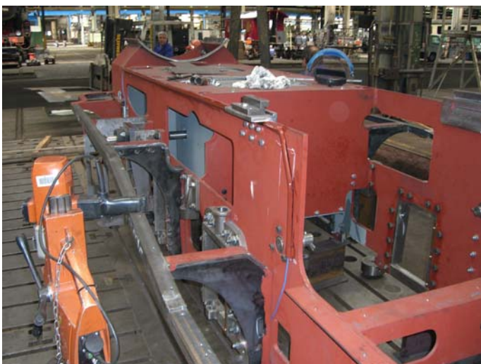
Anbau des Stahlpanzerrohres für das Elektrokabel an der linken Rahmenwange.
