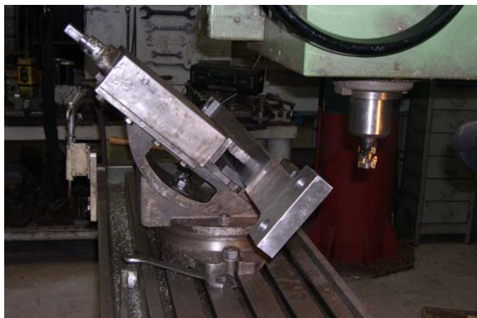
Endbearbeitung der Gleitbahnträger auf der Fräsmaschine.
