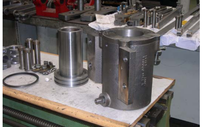
Die Komponenten der Dampfbremse sind fertig bearbeitet.
