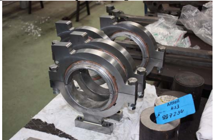
Exzenter scheiben mit Rotgusslagerhalbringen und unbearbeitetem Weißmetallausguss
