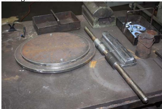
Einzelteile für den Zusammenbau der Feuertür. (28.4.)
