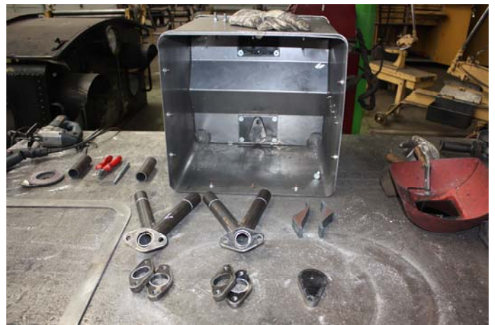
Die Sandstreumechanik im Sandkasten wird angefertigt und am Kasten schrittweise vervollständigt.
