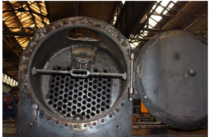
Rauchkammer mit Schornsteinöffnung und Einströmzweigrohr.
