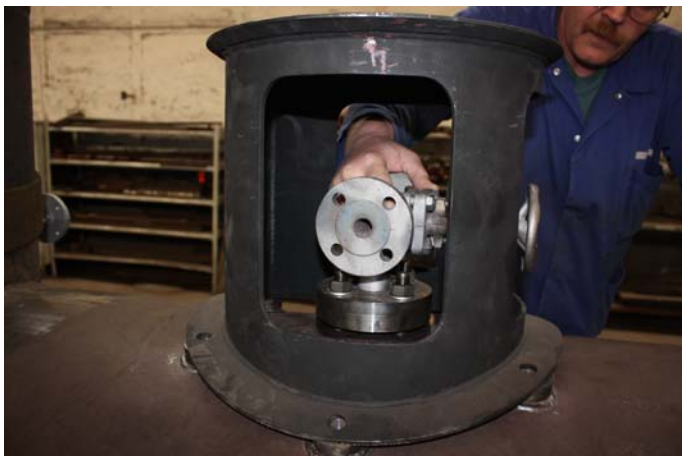
Anbau der Ventiles für die Elevatoranschlüsse unter dem Glockenfuß.
