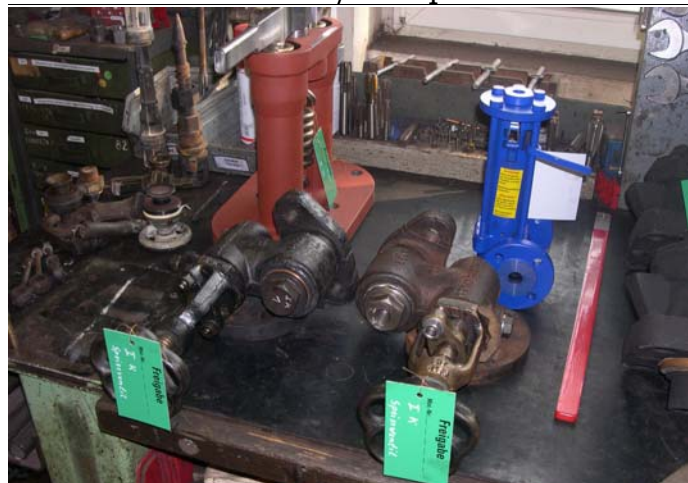
KSV und Abschlammventil hinten, Speiseventile vorn Rechts: Rohr für Gruppenventil
