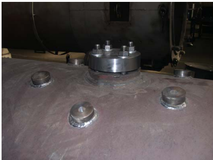
Arbeiten am Kessel: Befestigungen für Lötewerkunterbau und Flansch angebracht, Reglerstopfbuchsgehäuse montiert, Weiterhin Arbeiten am Domdeckel (für Öler/KSV-Öffnungen), Absprachen zum Einbau Feuerschirm erfolgt
