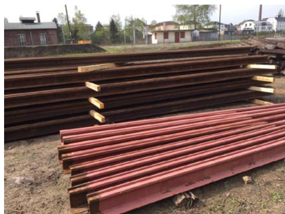
Rillen- und Übergangsschienen für die Fahrzeugunterstellung
